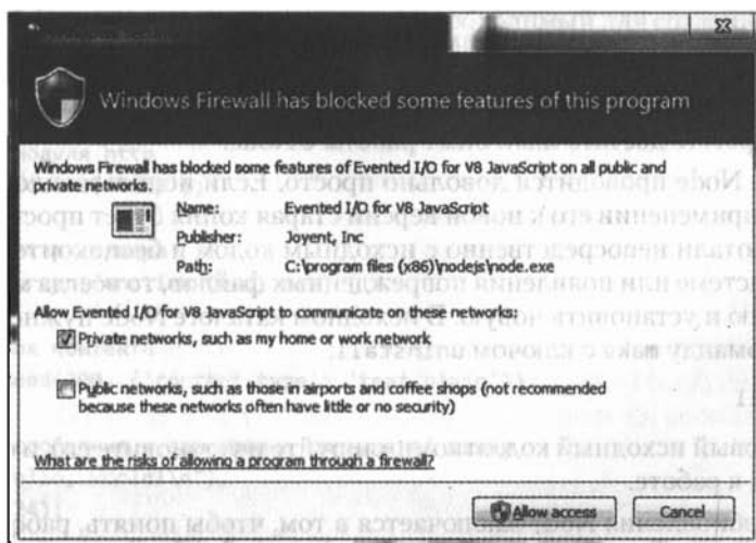
Рис. 1.6. Предупреждение о том, что брандмауэр Windows заблокировал Node-приложение, и вариант обхода этой блокировки
